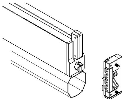
WIND BLOCK: Automatisches Blockier System des Ausfallprofiles an der Screeny 110 und 130 mit Führungsschiene GPZ C, GPZ und GPZ Unica. Unter Windeinwirkung wird das Ausfallprofil in der unteren Position blockiert, und das Tuch bei vollständig offener Markise gespannt.
